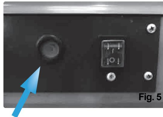
Si le chauffage manque de carburant, le voyant de verrouillage s'allume. Réapprovisionner l'appareil en carburant et appuyer sur le bouton de réinitialisation (RESET).
